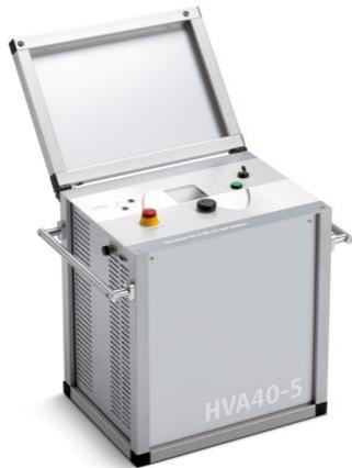
HVA40-5 是一款非常便攜的 VLF 測試儀，用於確定中壓電纜的狀態。它可以進行 VLF 和直流測試，還可以使用鐵護套故障定位模式進行鐵護套測試。它也是 HVA 系列的一員，具有非常高的輸出電流，最高可達 120mA，大大擴展了電纜的負載能力和可測試的長度。
