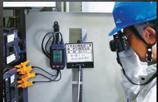
相序·接地相·三相電壓值在同介面顯示 可直接使用於工程用證明照片
