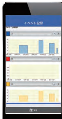
記錄間歇漏電的發生
